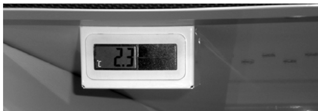
Fig. 2 : Affichage de la température intérieure (représentation par symbole)
